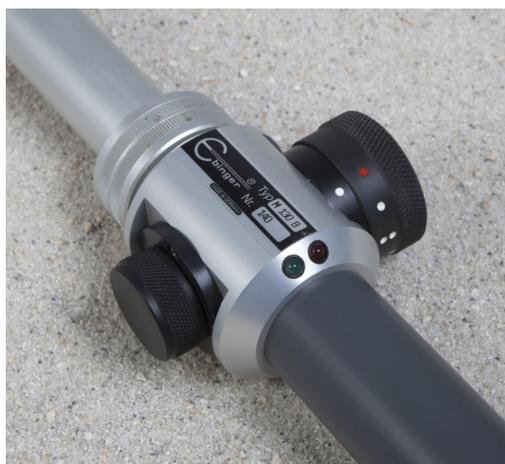
Le magnétomètre MAGNEX® 130 B comporte trois modes de détection avec différentes sensibilités.
