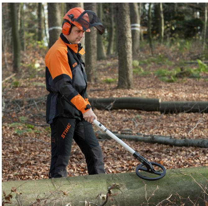
Le détecteur de fragments **EB 450 S** a été spécialement conçu pour les industriels de la forêt et du bois. Il est fabriqué selon une technique tubulaire et modulaire : tous les composants de ce matériel sont intégrés dans un tube, ce qui supprime l'utilisation des câbles de raccordement qui sont souvent à l'origine de pannes. Le compartiment à pile est démontable pour faciliter le transport.
