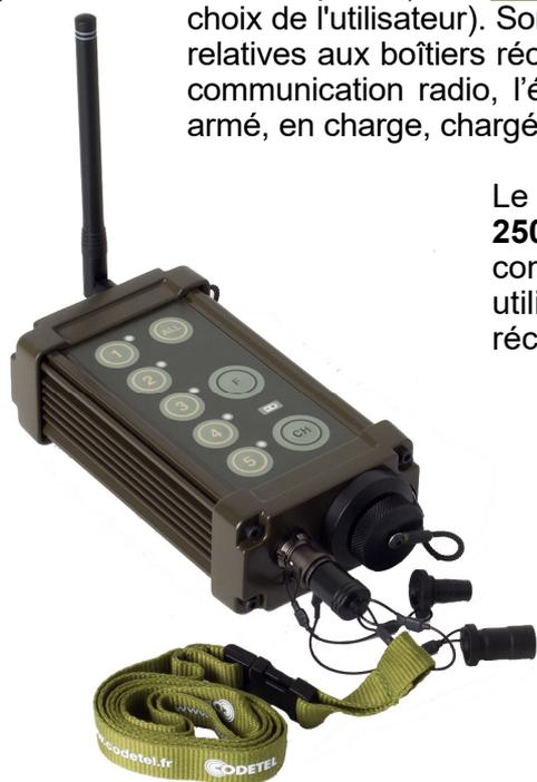
Le fonctionnement de l'exploseur **ATLAS-250 RC** est extrêmement simple et intuitif. La séquence de tir se compose de plusieurs étapes, afin de garantir la sécurité des utilisateurs : le délai de sécurité, l'armement du ou des boîtiers récepteurs, la charge des condensateurs, et la mise à feu.
