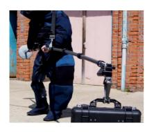
La pince est positionnée à l'extrémité de la perche, à 3 mètres de l'opérateur. Cette distance augmente la sécurité en cas d'explosion imprévue. Le dernier tube rallonge est « pré-cassé ». En cas d'explosion, celui ci va se désolidariser du suivant immédiatement, afin de réduire de significative les forces transférées le long de la perche jusqu'à l'opérateur.
