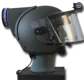
Le casque Sentinel comprend : la coque casque avec harnais garni d'une doublure de confort et équipé d'une mentonnière ajustable, visière disposant de trois positions de blocage (bas, milieu et haut), ventilateur faible bruit avec réglage de la vitesse et indicateur de charge de la batterie. Torche à LED montée sur le casque. Réserves pour microphone et écouteurs. Le casque Sentinel est compatible CBRN.
