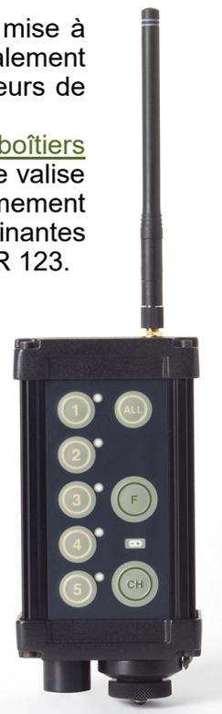
Le boîtier de commande permet de piloter à distance chacun des boîtiers récepteurs individuellement (uniquement un boîtier récepteur), ou simultanément par groupe (plusieurs boîtiers récepteurs, au choix de l'utilisateur). Son panneau de contrôle indique les données relatives aux boîtiers récepteurs : tension de batterie, état de la communication radio, niveau de charge des condensateurs, défauts.
