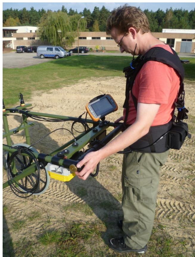
Après les opérations de détection, les données sont transférées dans un ordinateur PC. Les logiciels **DLMGPS** et **MAGNETO** permettent de traiter les données enregistrées, de créer une cartographie couleur de la zone, de localiser les objets détectés et déterminer leurs caractéristiques.
