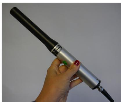
La sonde magnétique est une sonde passive pour la réception des impulsions magnétiques de timers ainsi que de signaux créés par des oscillateurs de récepteurs locaux.
