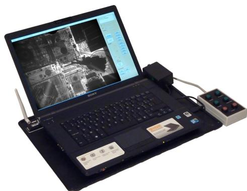
Connexion sans fil entre le boîtier de prise d'images et le générateur de rayons-X
