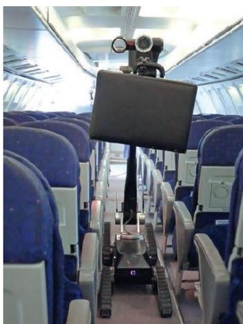
Le châssis du GUARDIAN a été développé pour lui offrir une plate-forme extrêmement stable tout en restant maniable. Les chenilles sont capables de rotation à 360 degrés continus et sont indépendantes par paires avant et arrière, assurant une grande polyvalence de positionnement, et ainsi des capacités de franchissement d'obstacle ou de montée d'escalier inégales.
