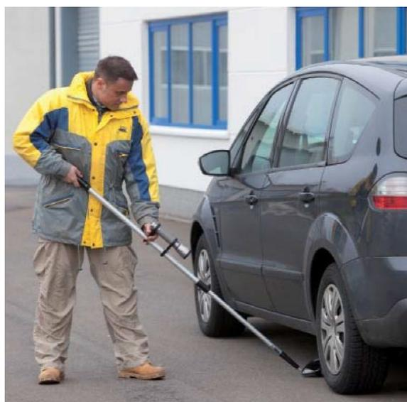
Les miroirs d'inspection EFIS® ont été conçus pour faciliter l'inspection des véhicules et des parties de bâtiments difficiles d'accès. Il existe différents domaines d'application : le dessous des véhicules, les porte-bagages, au-dessus ou en-dessous des meubles, les parties creuses des bâtiments, les trains, les avions, les bateaux...
