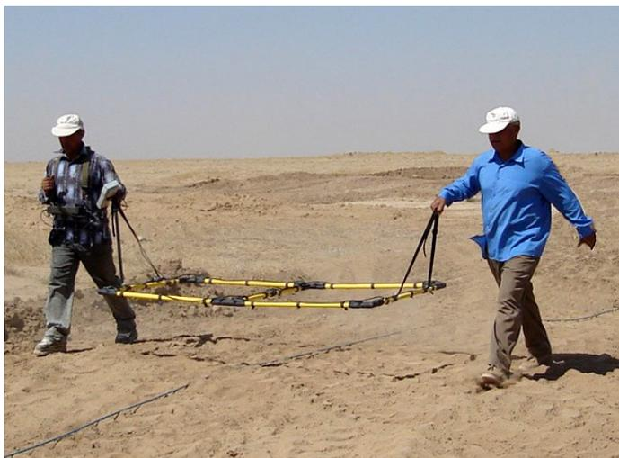
La dernière génération de grande boucle UPEX@740M offre une efficacité accrue. Ce système de détection flexible de 1-2 m<sup>2</sup> facilite les levés de terrains avec un niveau de profondeur de détection élevé. Pour s'adapter aux conditions de recherche locales, ce nouvel appareil est équipé de 3 niveaux de sensibilité : bas / moyen / élevé. Une bombe MK 82 peut être détectée au niveau de sensibilité MOYEN à une profondeur approximative de 3 m.
