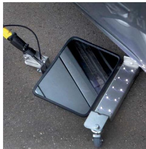
Le tube rallonge télescopique peut être ajusté en fonction de la taille des opérateurs. Il peut être allongé pour atteindre les parties difficilement accessibles des grands véhicules. L'EFIS® 4 est en outre équipé d'une télécommande mécanique de l'angle du miroir
