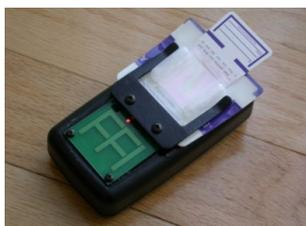
**Réchauffeur alimenté par batterie** – Le réchauffeur portable est alimenté par une batterie rechargeable Ni-MH qui permet une autonomie de 8 heures d'utilisation normale par intermittence. Il augmente la gamme de détection du EL100 ainsi que son niveau de sensibilité.
