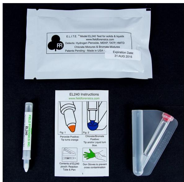
Les kits de détection ELITE® ont été conçus pour être utilisés dans des conditions très différentes et par divers types d'utilisateurs.
