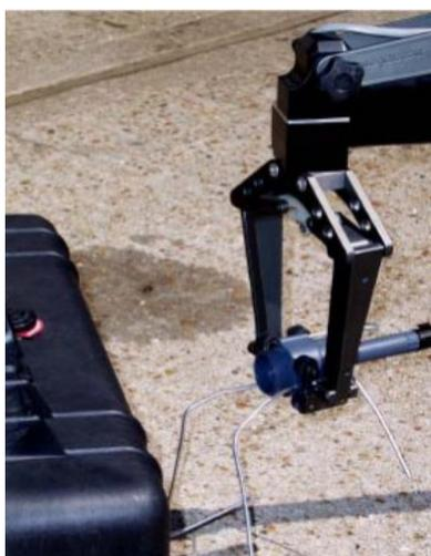
Le contrepoids réglable, à l'extrémité arrière, permet de conserver un bon équilibre de l'appareil pendant son utilisation, et permet à l'opérateur de transporter plus facilement l'objet suspect après son relevage. Un réglage fin la position d'équilibre peut être effectué en avançant ou reculant la perche par rapport à la sangle de transport.
