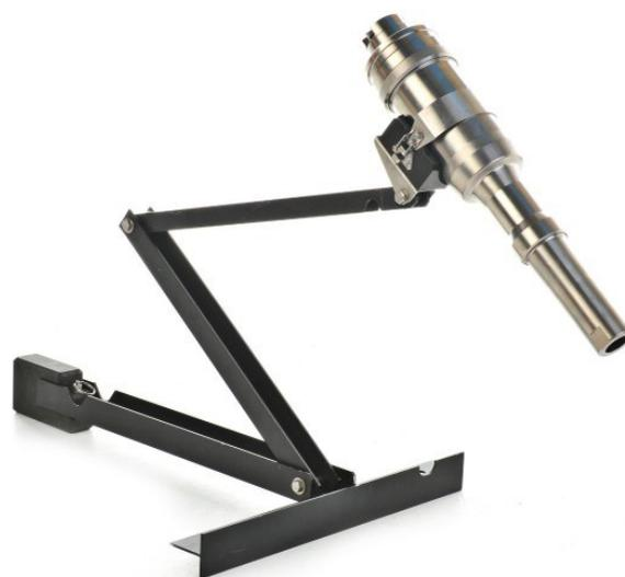
L'ABL-3000 a été conçu pour offrir un emploi dual. En remplaçant le canon « disrupteur » par le canon « de-arder », proposé en option, et par l'emploi de projectiles appropriés, l'ABL-3000 se transforme en de-arder capable de tirer une gamme de projectiles solides tels que burins, lames, fourches, scalpels ...
