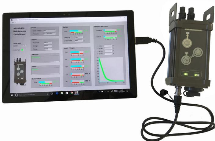
L'**ATLAS 450** est alimenté par trois piles lithium CR 123, extrêmement répandues dans les Forces. Une led bicolore indique en permanence l'état de charge.
