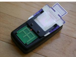
**Réchauffeur alimenté par batterie** – Le réchauffeur portable est alimenté par une batterie rechargeable Ni-MH qui permet une autonomie de 8 heures d'utilisation normale par intermittence. Il augmente la gamme de détection du EL100 ainsi que son niveau de sensibilité.
