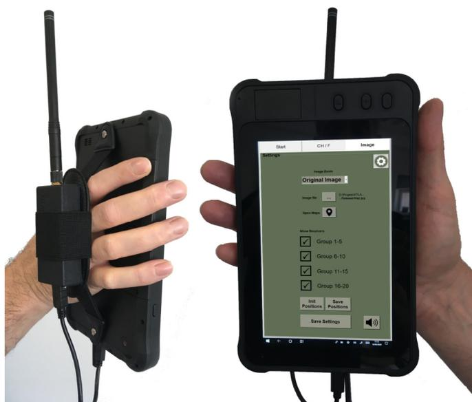
Un logiciel simple d'utilisation permet de commander les boîtiers récepteurs en toute sécurité. Plusieurs onglets permettent d'avoir une vue claire des informations disponibles. L'utilisateur peut personnaliser le logiciel en important une vue aérienne de la zone, sur laquelle les boîtiers récepteurs peuvent être matérialisés. Ceci permet d'avoir une vue globale
