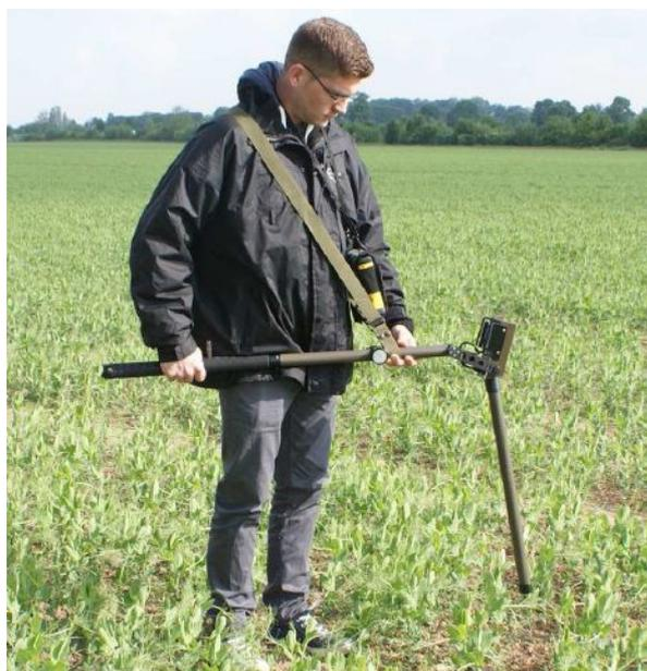
Ce matériel est conçu comme un magnétomètre différentiel à deux bobines qui sont sensibles au magnétisme. Cette conception supprime l'indication du champ magnétique naturel. Les capteurs (bobines) sont placés en position coaxiale à l'intérieur de la sonde. Lorsque la sonde est en présence d'anomalies magnétiques, celles-ci sont indiquées par un signal audio et une déviation du galvanomètre.
