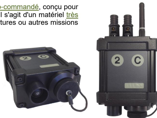
Les boîtiers récepteurs commandent chacun 1 ligne de tir et intègre un test de continuité de ligne. Ils sont équipés de bornes permettant de bloquer les fils par pincement, ou de connecter des fiches bananes de 4 mm.
