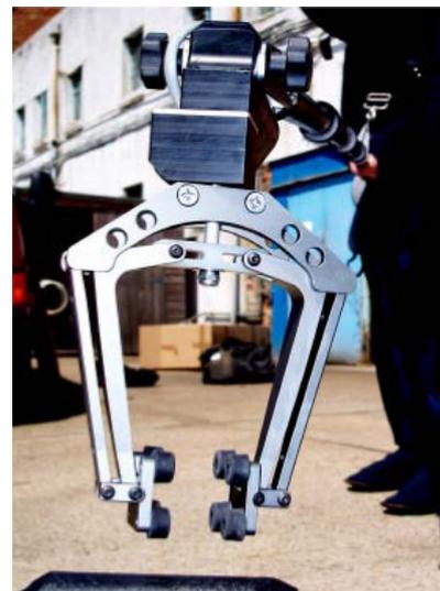
La pince robotisée est capable de manipuler des disrupteurs, des systèmes de radioscopie, et une multitude d'outils servant à
