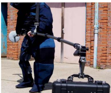
La pince est positionnée à l'extrémité de la perche, à 3 mètres de l'opérateur. Cette distance augmente la sécurité en cas d'explosion imprévue. Le dernier tube rallonge est « pré-cassé ». En cas d'explosion, celui ci va se désolidariser du suivant immédiatement, afin de réduire de façon significative les forces transférées le long de la perche jusqu'à l'opérateur.
