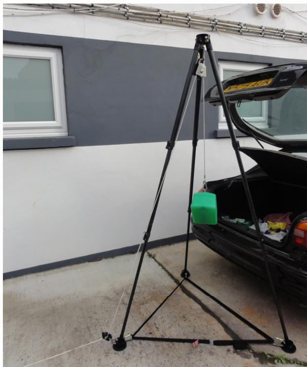
Un trépied léger utilisé en conjonction avec d'autres équipements hook & line, offrant la possibilité de soulever et déplacer des objets jusqu'à 75 kg.
