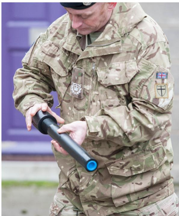
Le **Mantis** est un disrupteur d'usage général, léger, et à utilisation unique, capable d'effectuer des opérations de neutralisation d'EEL cachés dans des malles, valises...
